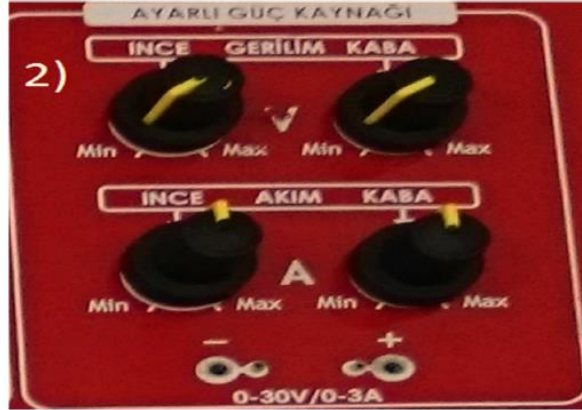
Şekil 1.7 Ayarlanabilir Gerilim Kaynağı
