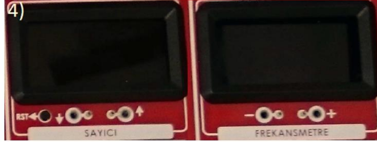
Şekil 1.9 Frekansmetre ve Sayıcı
