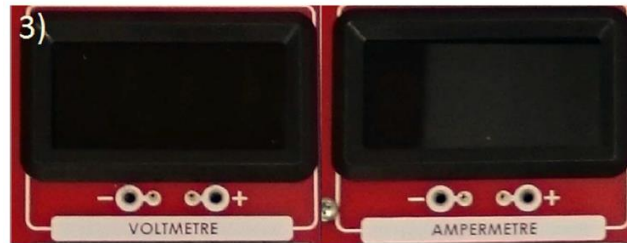
Şekil 1.8 Voltmetre ve Ampermetre
