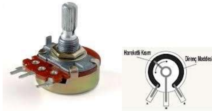
Şekil-6 Potansiyometre ve iç yapısı
