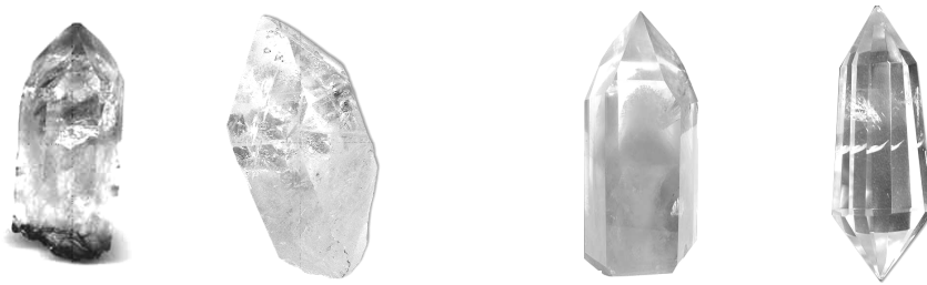
Şekil 16.1 : Quartz kristalinin doğal ve işlenmiş görüntüleri
