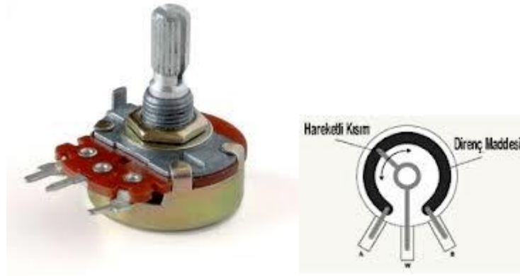
Şekil-6 Potansiyometre ve iç yapısı
