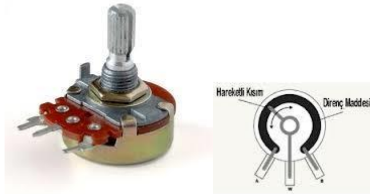
Şekil-6 Potansiyometre ve iç yapısı
