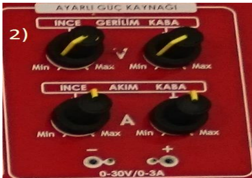
Şekil 3 Ayarlanabilir Gerilim Kaynağı
